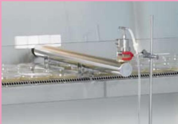
**Abb. 3** Teststand mikrobiologische Prüfung des Produktschutzes.
