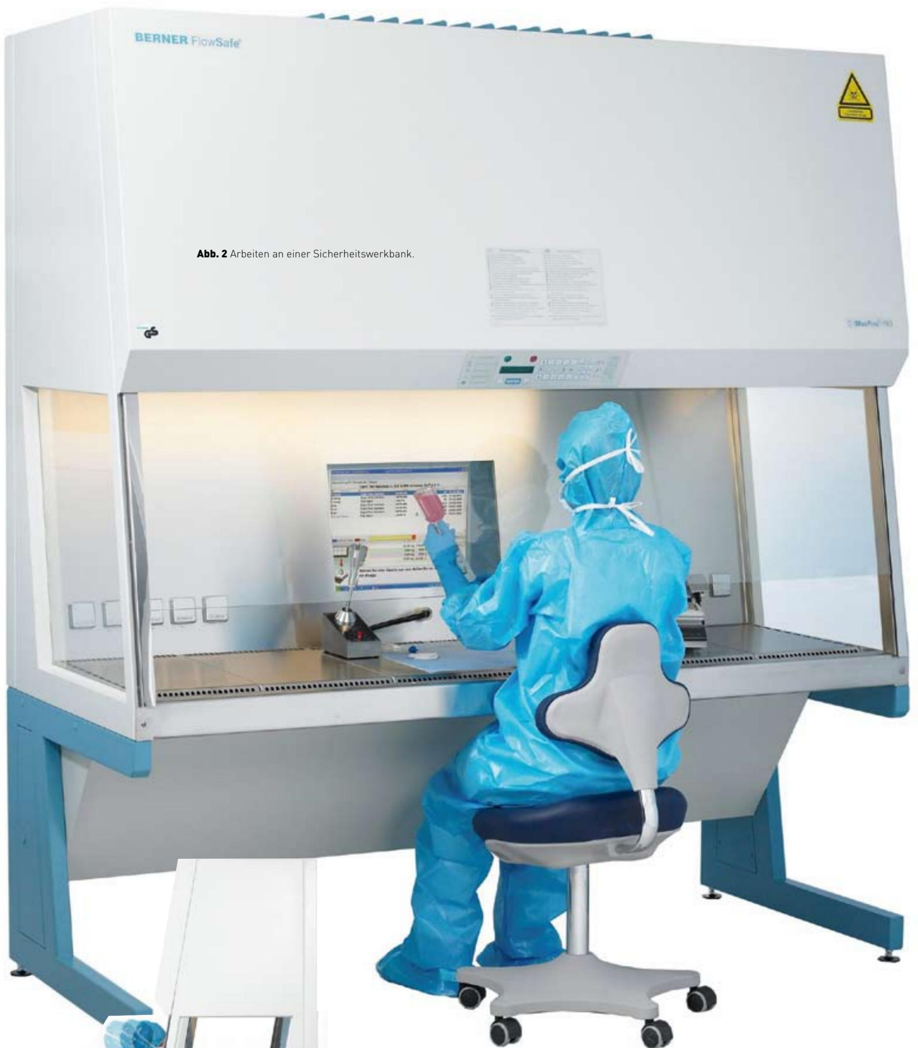
**Abb. 2** Arbeiten an einer Sicherheitswerkbank.
