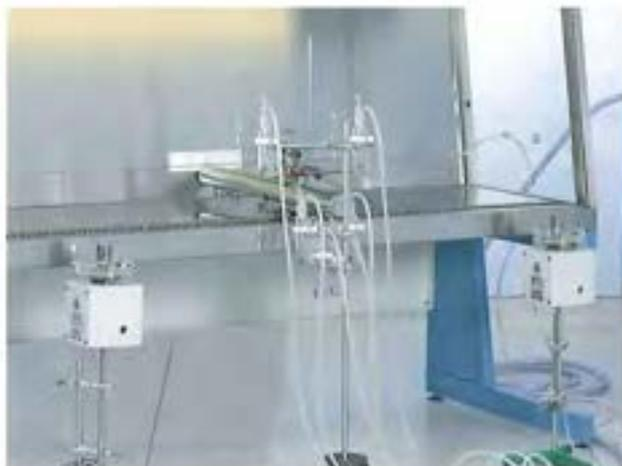
Abb. 1: Prüfstand der mikrobiologischen Prüfung des Personenschutzes gem. DIN EN 12469.
