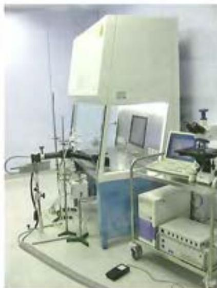
Abb. 5: Störung „Bewegter Arm in der Arbeitsöffnung und im Arbeitsraum“ während der Prüfung des Personenschutzes
