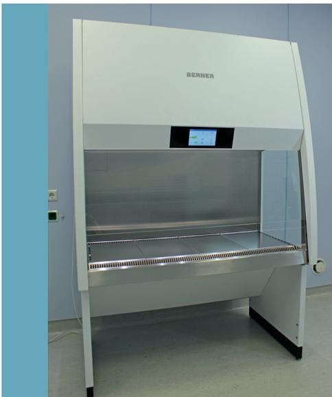
**Abb. 2:** Sicherheitswerkbank für Zytostatika (SfZ)
