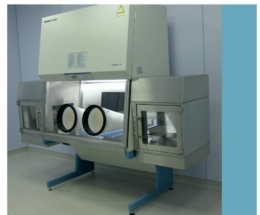
**Abb. 1:** Isolator für Zytostatika (IfZ)
