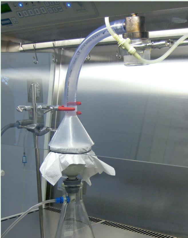
**Abb. 2:** Prüfeinrichtung mit Vernebler, Büchner-Trichter und Saugflasche
